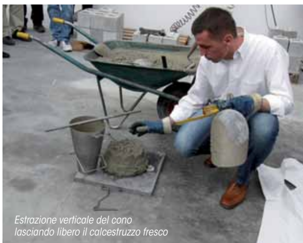
Misura dell'abbassamento (SLUMP mm)
