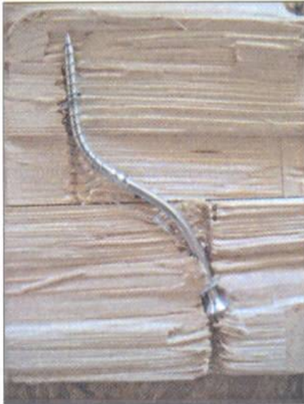
Figura 1 - Comportamento a taglio di una vite per legno
