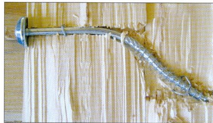
Applicazione vite con rondella (CR)
