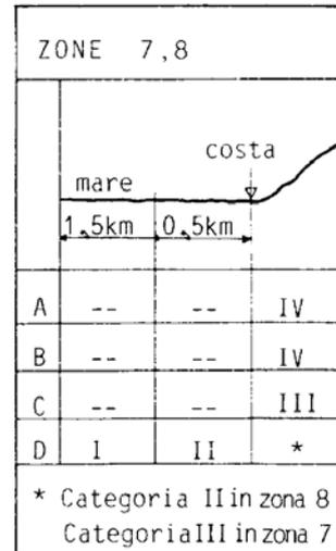
Il coefficiente di topografia  $c_f$  è posto di regola pari a 1 sia per le zone pianeggianti sia per quelle ondulate, collinose, montane. In questo caso la Figura 7.3. riporta i diagrammi di  $c_e$  per le diverse categorie di esposizione.
